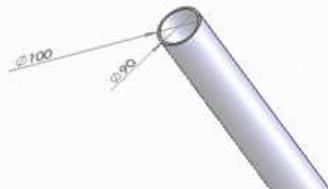
Fig. 3. Poste vertical de sección anular
